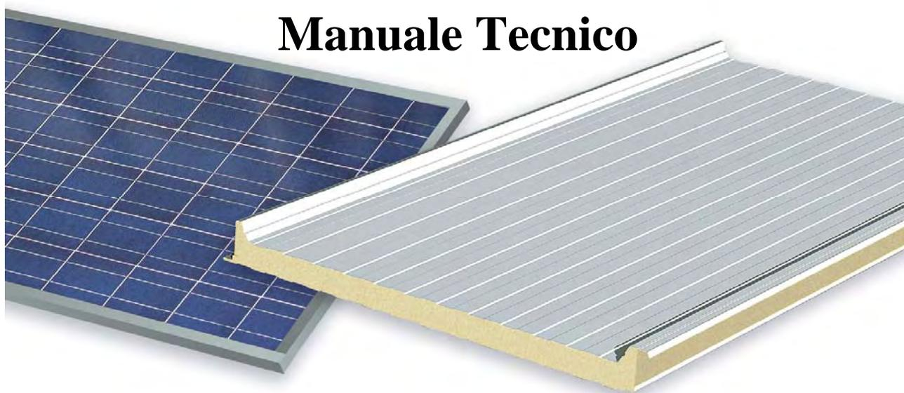
Il Sistema Italvoltaico è costituito da un pannello sandwich a 2 greche (Altezza Greche 50 mm; Larghezza Variabile da 623 mm a 1.113 mm) predisposto per l'alloggiamento dei moduli fotovoltaici, completo di coprigiunto e cappello di serraggio.
